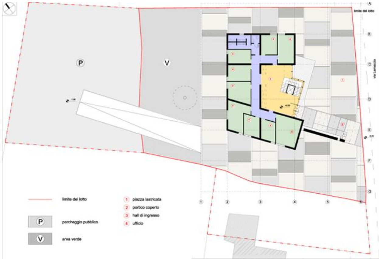
Progetto ENEA–ANDIL a Sulmona: pianta piano terra, con legenda delle funzioni.
