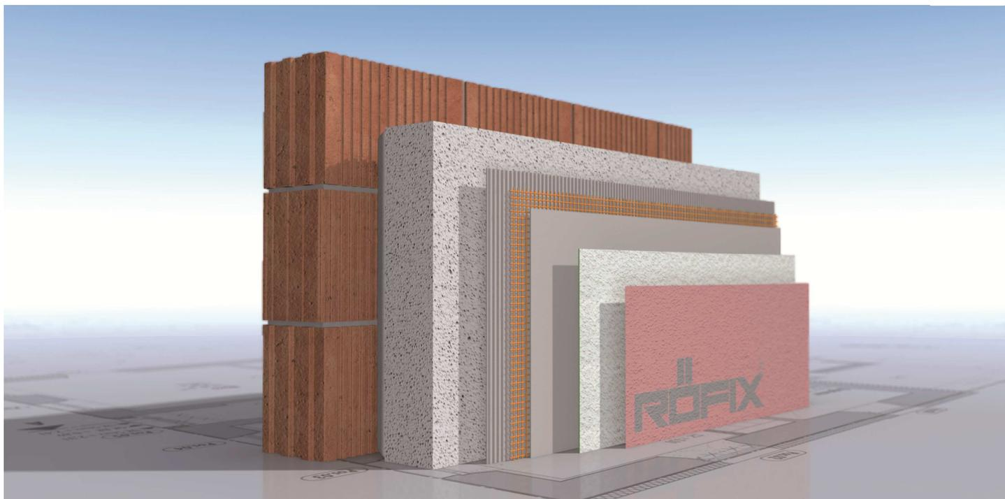
Sistema d'isolamento termico a cappotto **RÖFIX MINOPOR** con pannelli a base di idrati di silicato di calcio, certificato ETA 06/0184 secondo ETAG 004. Classe di reazione al fuoco A2-s1,d0 (secondo EN13501-1). Certificato di sostenibilità Natureplus®.
