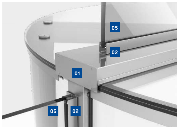
Dettaglio di esecuzione esempio di una facciata interamente in vetro
