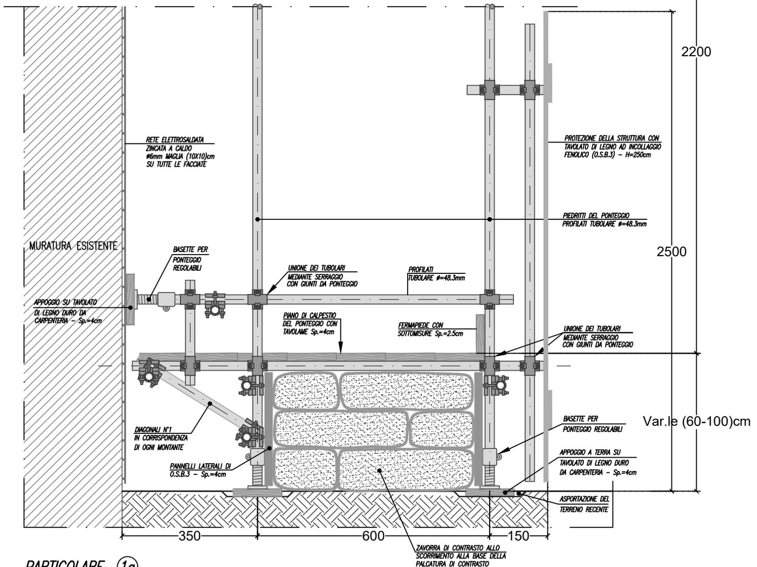
**PARTICOLARE ①a APPOGGIO A TERRA E ZAVORRA CONTRO LA TRASLAZIONE DELLA STRUTTURA DI SOSTEGNO SEZIONE TRASVERSALE TIPO**
