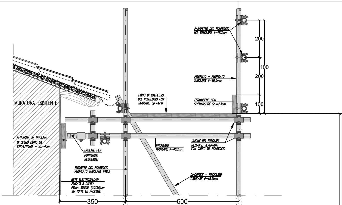
**PARTICOLARE ① - ELEMENTI DI CONTRASTO ALLE MURATURA SEZIONE TRASVERSALE TIPO**
