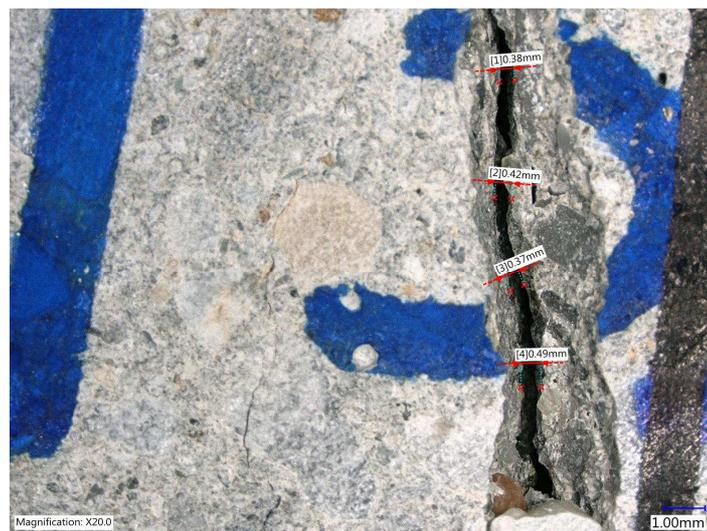
Le Figure 2.3 e 2.4 mostrano la crescita dei cristalli avvenuta sulla fessura sottoposta al flusso alla fine del test.
