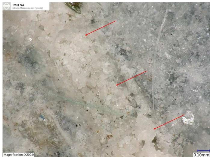
Figura 2.7. ID 11330AK - Presenza omogenea di cristalli del prodotto di reazione
