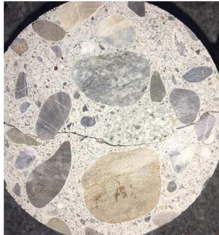
Il flusso continuo di acqua di rete attraverso i campioni fessurati viene registrato digitalmente con l'ausilio di flussimetri elettromagnetici.
