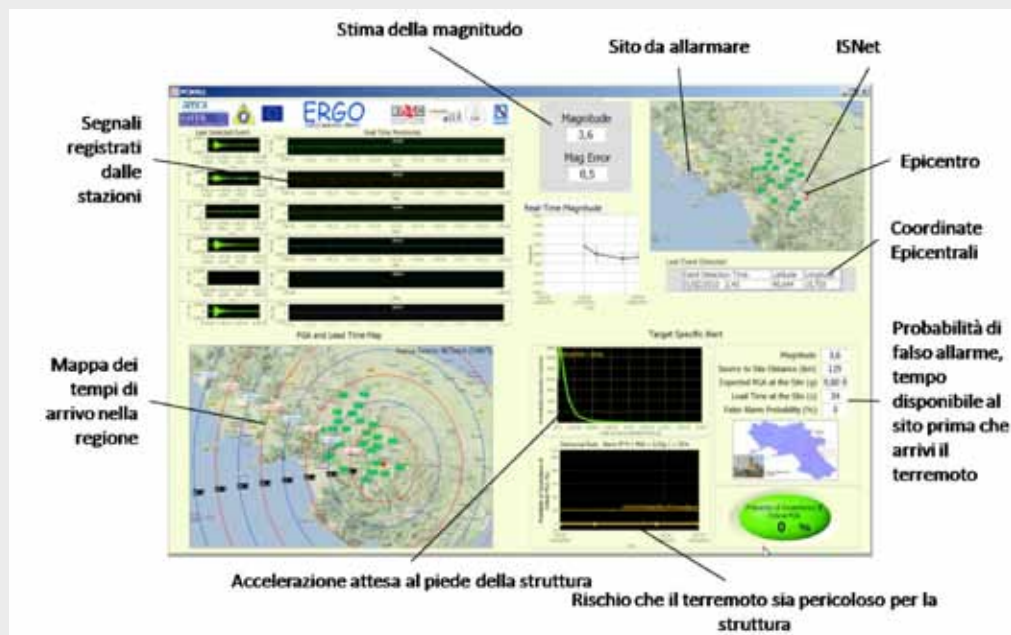
Figura 4. Sistema ERGO e un terremoto effettivamente rilevato nel febbraio 2010, la piccola magnitudo e l'elevata distanza dal sito in cui si trova il terminale hanno fatto sì che il sistema non lanciasse alcun allarme.
