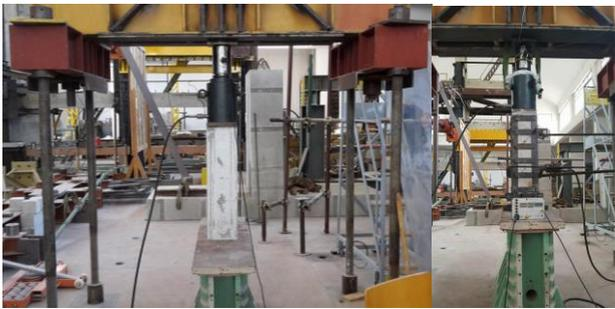
Figura 6. Specimen under preload and during strengthening / Campione sotto precarico e durante il rinforzo.
