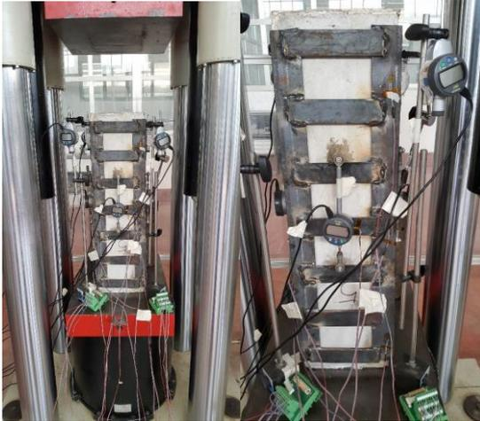
Figura 5. Strengthened specimens before the failure test / Campioni rinforzati prima del test di rottura.
