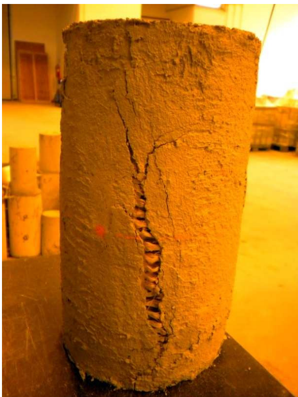
Figura 10. Rottura per strappo della fibra.
