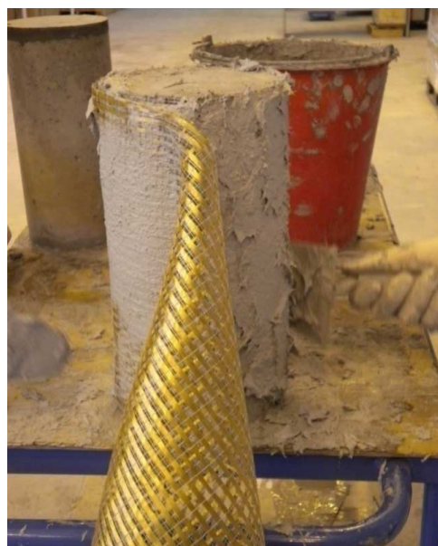
Figura 3. Fasi dell' applicazione di malta e fibra.
