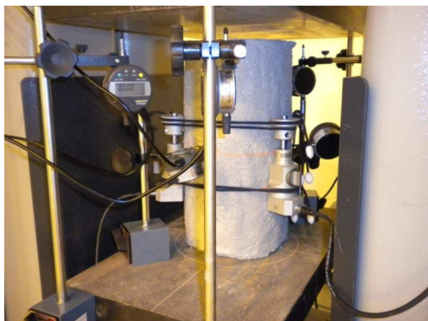
Figura 5. Setup di prova ed acquisizione dati per i provini cilindrici fasciati.
