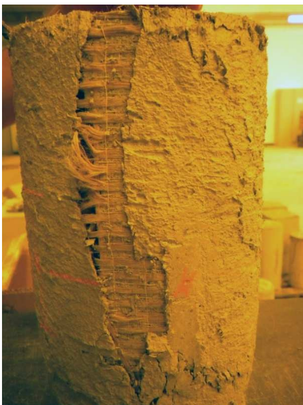
Figura 11. Rottura per strappo della fibra con esplosione del nucleo di calcestruzzo.
