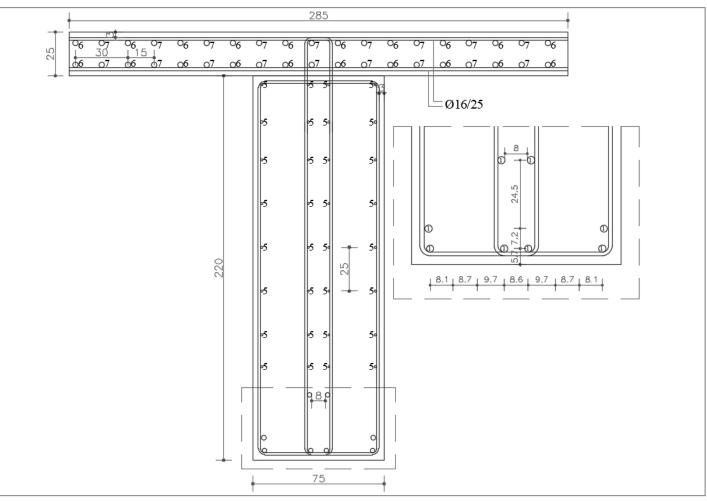
Figure 7. Girder: section E-E / Trave: sezione E-E.
