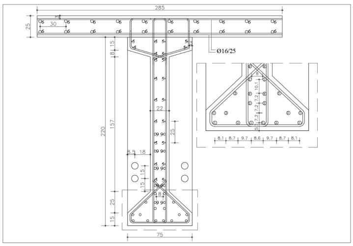
Figure 6. Girder: section D-D / Trave: sezione D-D.
