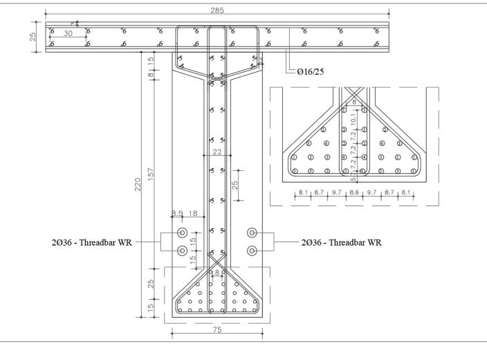
Figure 5. Girder: section A-A / Trave: sezione A-A.
