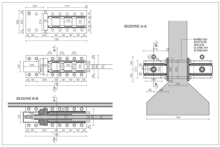
Figure 8. External prestressing bars' anchorage / Ancoraggio della barra di precompressione esterna.
