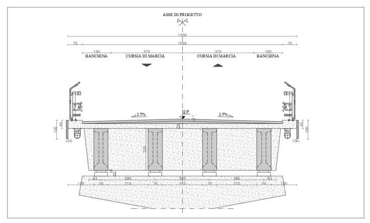
Figure 2. Bridge deck: cross section at pier / Impalcato: sezione trasversale in asse pila.
