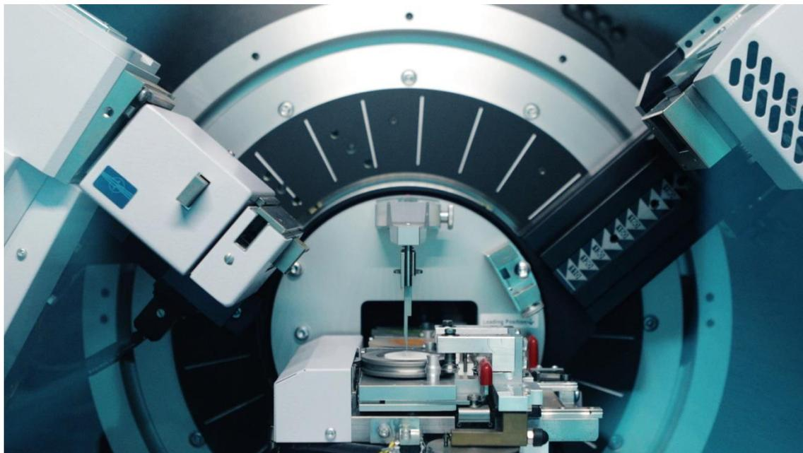
Diffrattometro a raggi X per le analisi XRD, all’interno del Fassa I-Lab
