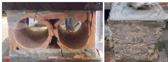
Figura 7. a) blocco in laterizio forato con doppia foratura circolare (*occhialone*); b) massello.
