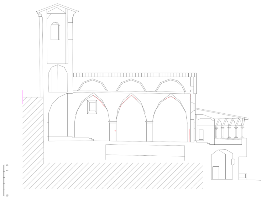
Figura 18. (a) Pianta della chiesa di Sant'Andrea. (b) Vista del sottotetto, in particolare dell'arcata longitudinale centrale che riporta il peso della copertura sui pilastri centrali. (c) Sezione longitudinale (da [5]).
