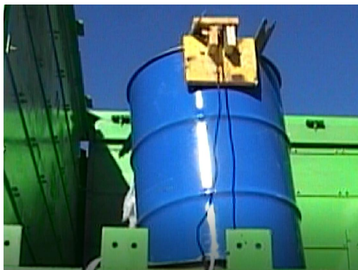
Attrezzatura per test di esplosione su liquidi infiammabili, credit ATECOS srl
