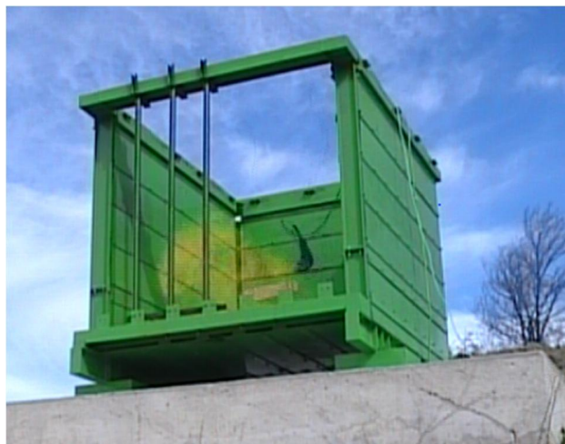
Tubazioni antincendio sottoposte a test di esplosione, credit ATECOS srl
