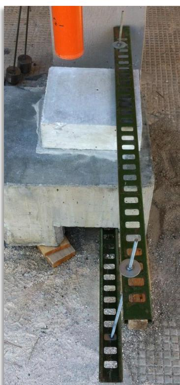
**Figura 8** - Bloccaggio del provino
