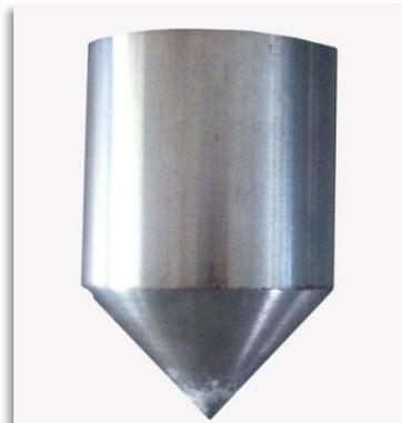
**Figura 4** - Proiettile con punta conica
