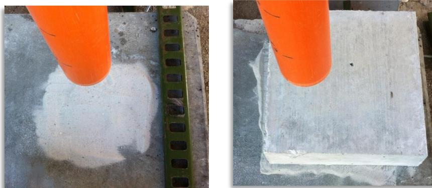
**Figura 6** - Quarzo per l'aderenza del provino **Figura 7** – Posizionamento del provino
