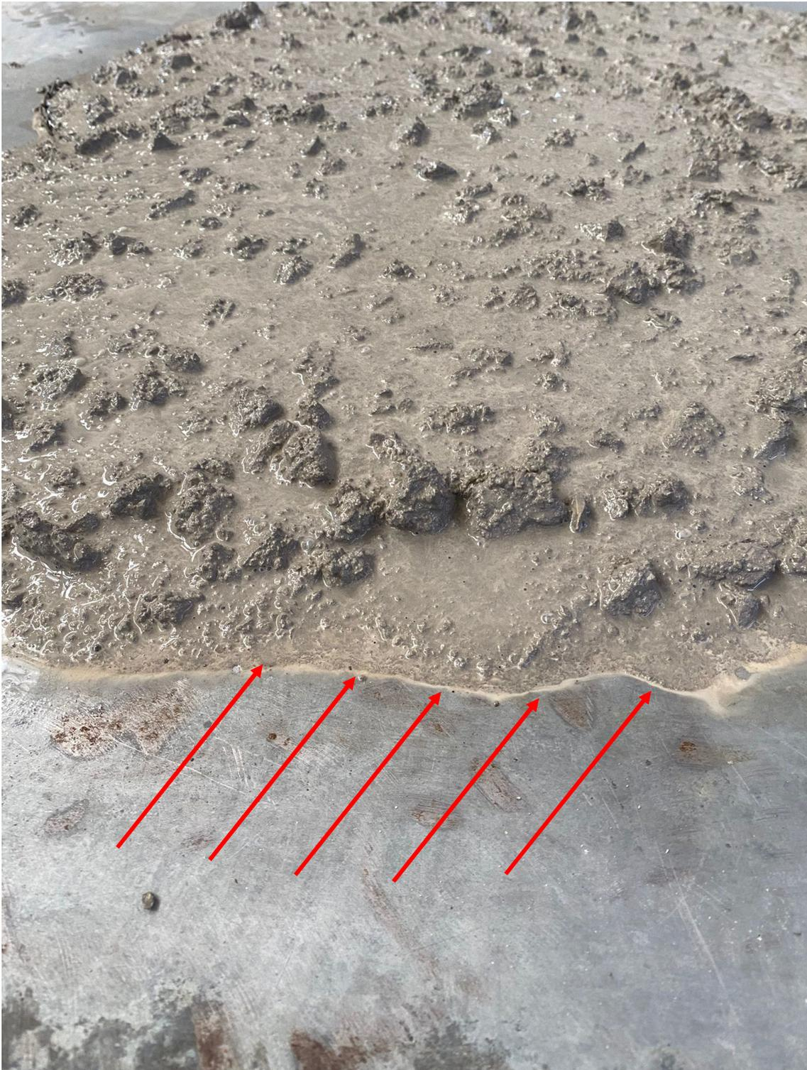
Figura 3: Dettaglio segregazione della miscela.
