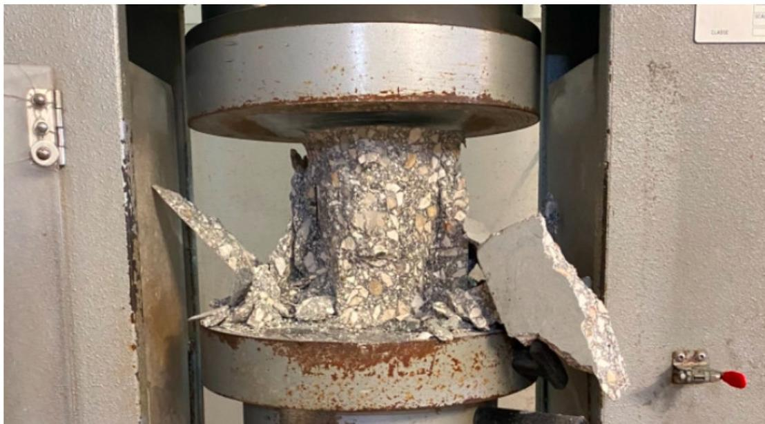
Figura 7: Dettaglio rottura a compressione di un provino in calcestruzzo prefabbricato Rck55, contenente CEM I 52.5 R.
