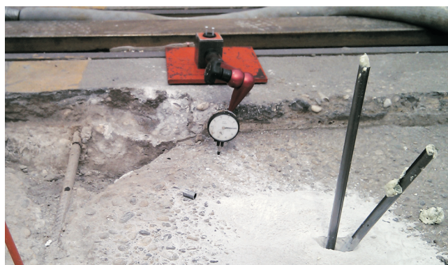
Comparatore centesimale utilizzato in prossimità di ogni verticale d'iniezione
