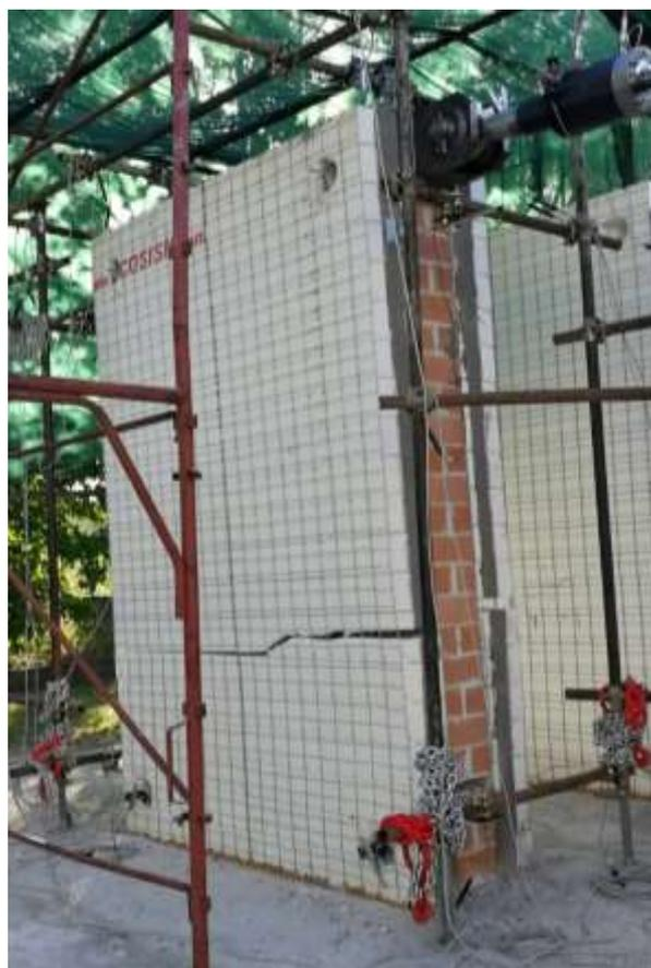
Figura 10. Rottura campione con muratura in laterizio
