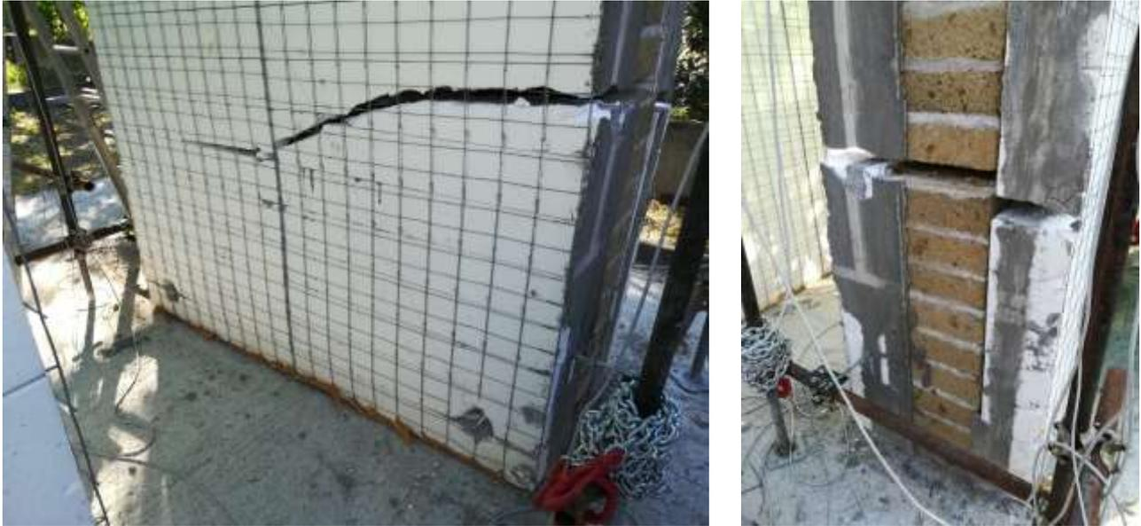
Figura 9. Rottura campione con muratura in tufo
