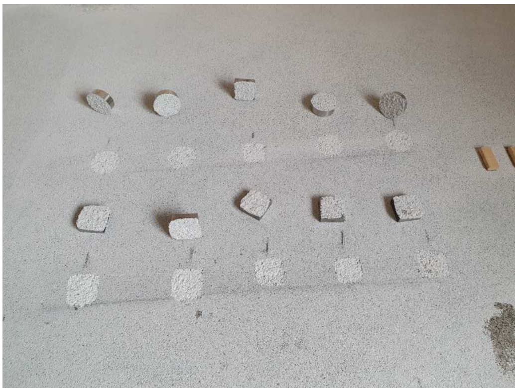
Fig. C.2 – Test per la determinazione della resistenza all'aderenza per trazione diretta in conformità all'Allegato C: 2 campioni da 5 strappi ciascuno.
