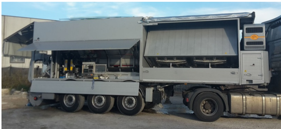
Fig. 6 – Esempio di impianto per la miscelazione e il pompaggio di massetti preconfezionati
