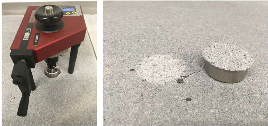
Fig. C.1 – Test per la determinazione della resistenza all'aderenza per trazione diretta UNI 8298-1
