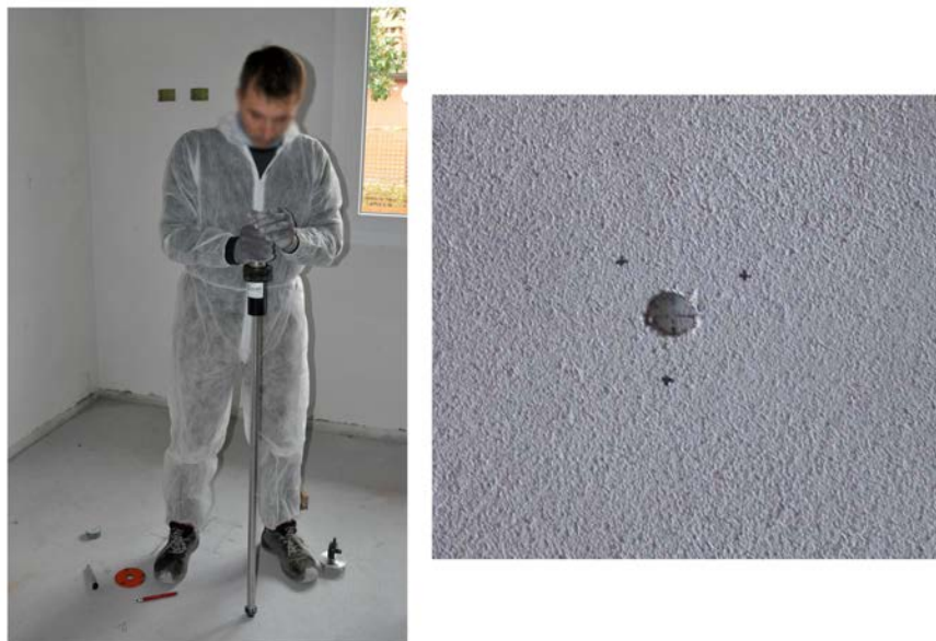
Fig. 15 – Test per determinazione della resistenza all’impatto
