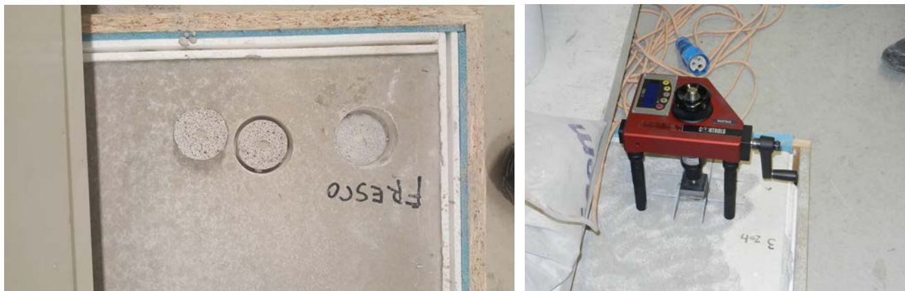
Fig. 18 – Test per determinazione della forza di adesione di un massetto al sottofondo, EN 13892-8 con tasselli a sezione circolare e quadrata.
