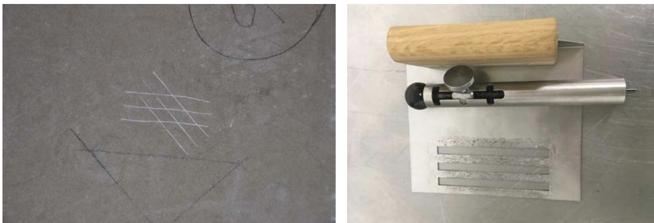
Fig. 17 – Test per determinazione della durezza superficiale
