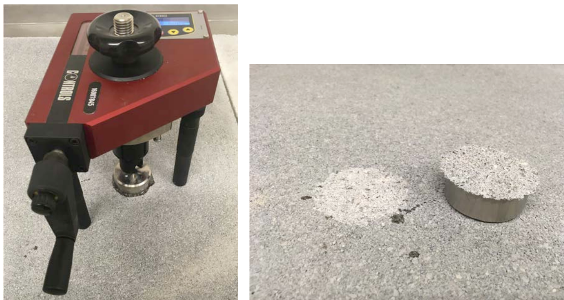
Fig. 19 – Test per determinazione della resistenza all'aderenza per trazione diretta UNI 8298-1
