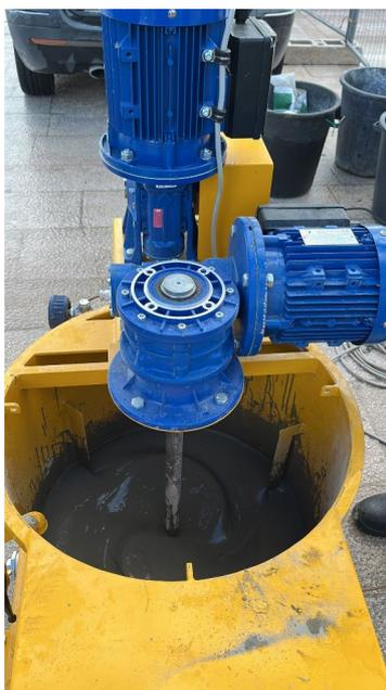
*Figura 2: Preparazione della boiaccia con FLUECO 77 CABLE*
