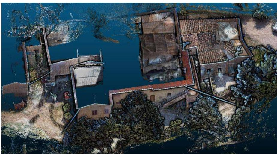
*Vista della nuvola di punti acquisita con il sistema Stonex X70GO, visualizzata senza alcuna elaborazione preliminare, utilizzando l'applicazione open source Cloud Compare Viewer (© Crisel)*
