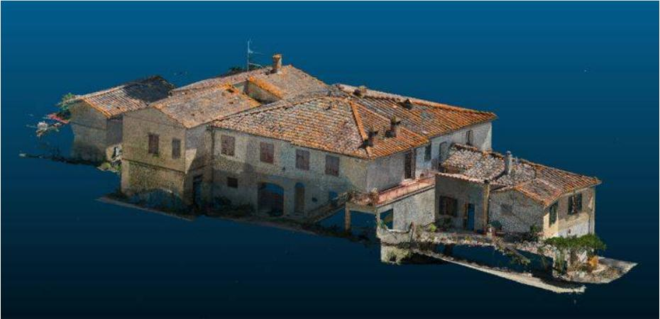
*Visualizzazione del modello 3D integrato delle coperture. Il rilievo delle coperture è stato realizzato con un sistema UAV. (© Crisel)*
