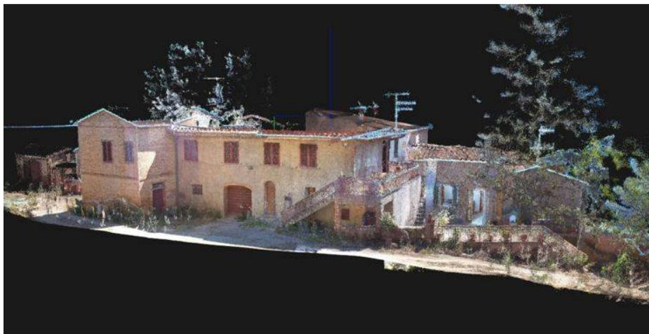
*Vista d'insieme della sola nuvola di punti (Point Cloud) della facciata principale. Rendering ottenuto con il software CUBE 3D. (© Crisel)*
