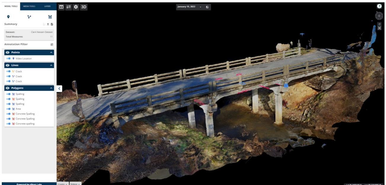
Fig. 7: Modello digitale creato in modo automatico nella piattaforma gNext a partire da fotografie geolocalizzate, video e rilievi laser scanner.
