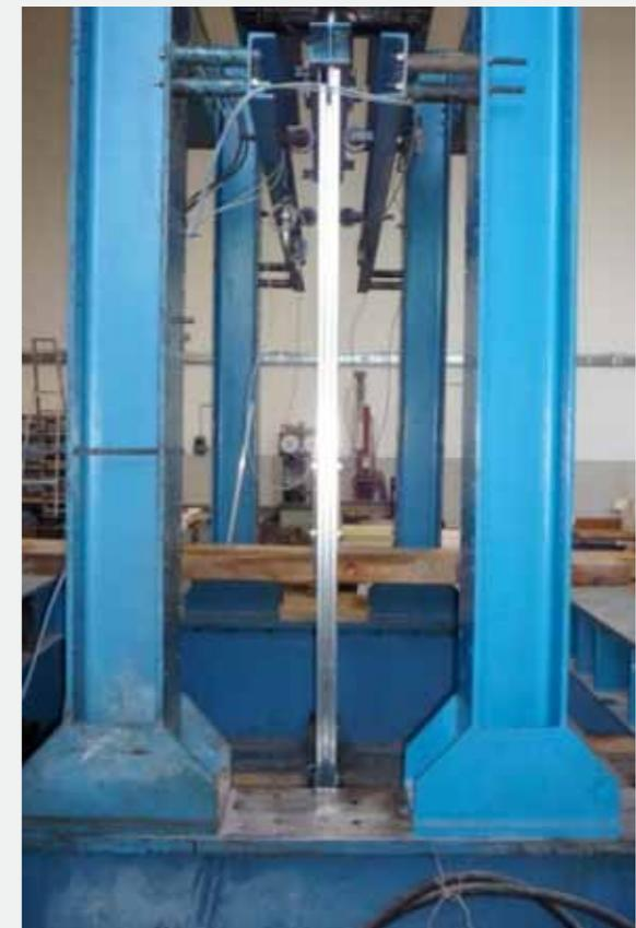
Pannello di Tipo 1 - prova di compressione semplice
