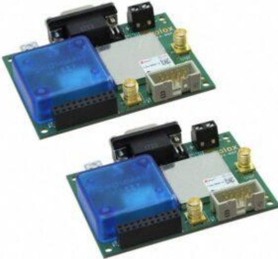
*Il sistema SDK di u-blox che comprende 2 antenne e 2 schede complete di radio-link UHF, per la realizzazione di prototipi di ROVER, UAV e sistemi robotici in genere*
