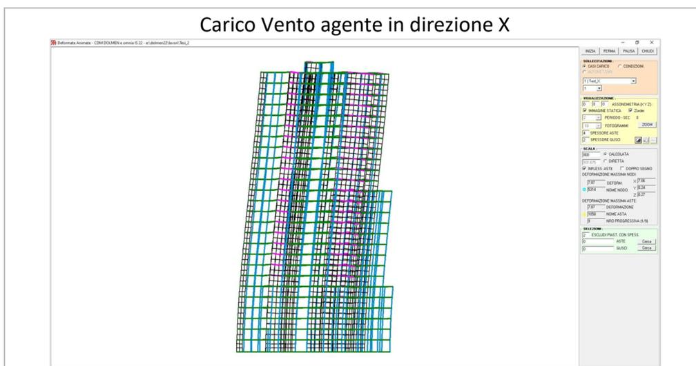
Figura 14 – Deformata per spostamenti lungo l'asse X dovuti al vento agente in direzione X ottenuti col Modello FEM realizzato con DOLMEN
