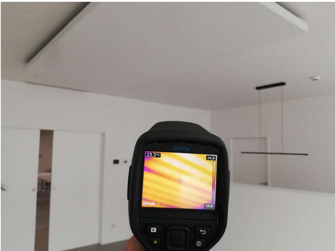
*Fig. 6 – Sistema radiante a vele metalliche e relativa visione termica*
