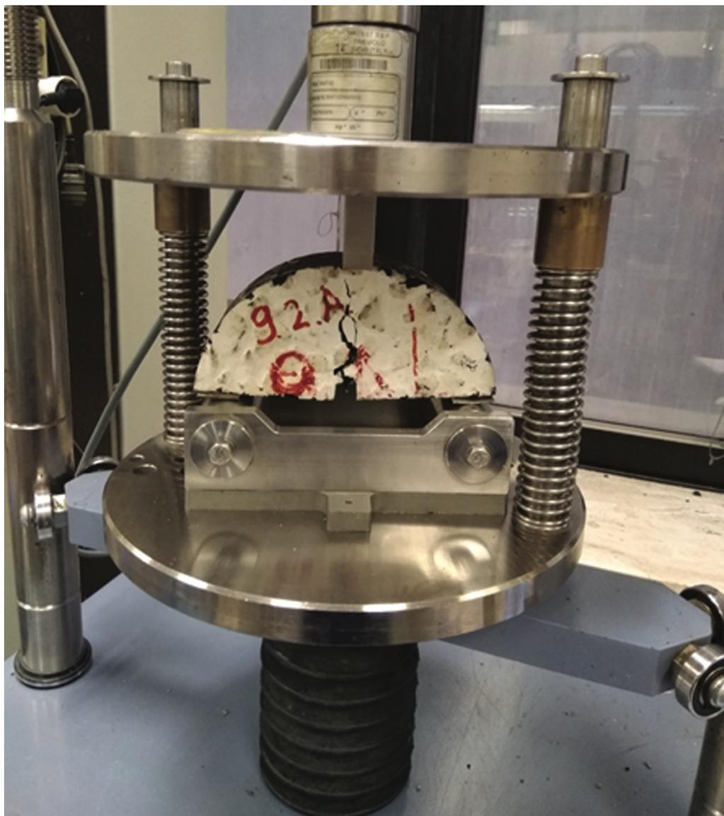
Dai valori misurati si è appurata una soglia di fratturazione elevata e la tendenza della pavimentazione ad opporre ulteriore resistenza alla propagazione della fessura una volta superata tale soglia.
