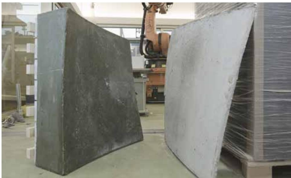
Figura 2. Doppio elemento in cera prodotto con un processo meccanico ed elemento complementare in calcestruzzo
