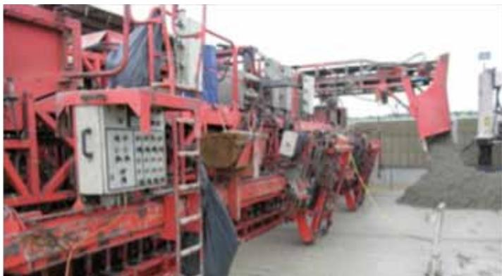
Figura 4. Macchina finitrice a cassaforma scorrevole
