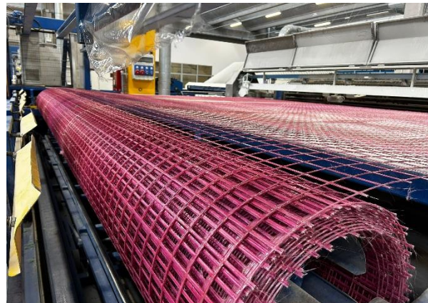
Figg. 2-3 produzione delle reti in GFRP RI-STRUTTURA e RI-STRUTTURA FORCE con tecnologia TEXTRUSION®
