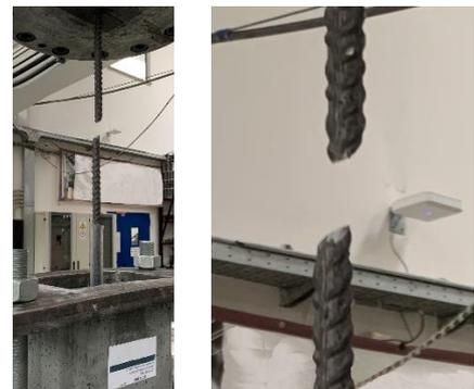
**Figura 3** – Prova di sfilamento di una barra Ø10 ancorata per soli 50 mm nel calcestruzzo
