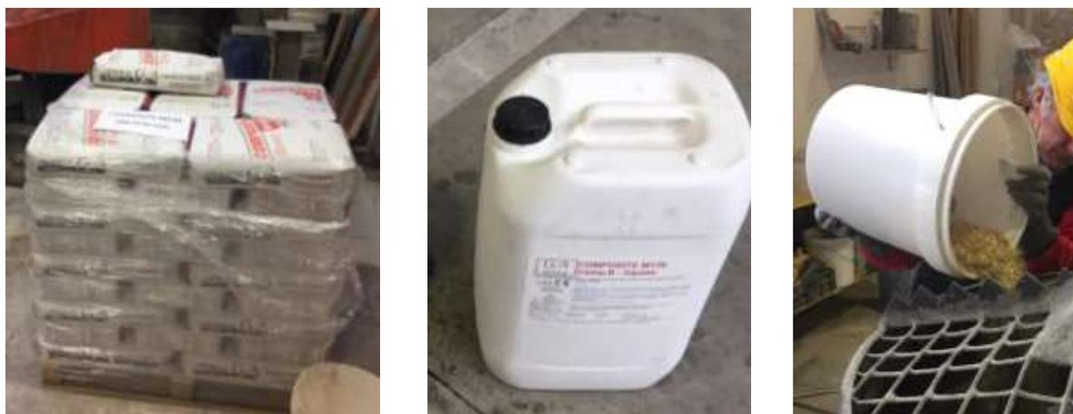
**Figura 6** – Diverse componenti del microcalcestruzzo **COMPOSITE M130**
