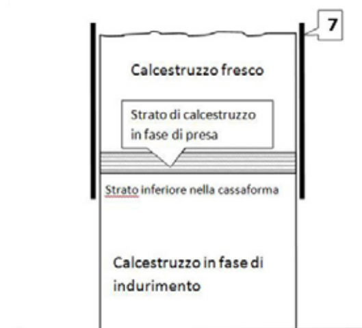
Figura 4. Evoluzione della resistenza del calcestruzzo durante lo scorrimento della slipform.
