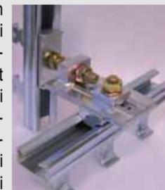
scorrevoli che consentono al nodo libertà di spostamento; particolari accorgimenti di forma del "Giunto GS" determinano una minore deformazione del profilo ed un minor danneggiamento del CLS di confinamento. Sono disponibili due tipologie di Giunti da abbinare a 4 diverse tipologie di profili con resistenze di progetto "Rd" comprese tra 11 kN e 32 kN.
