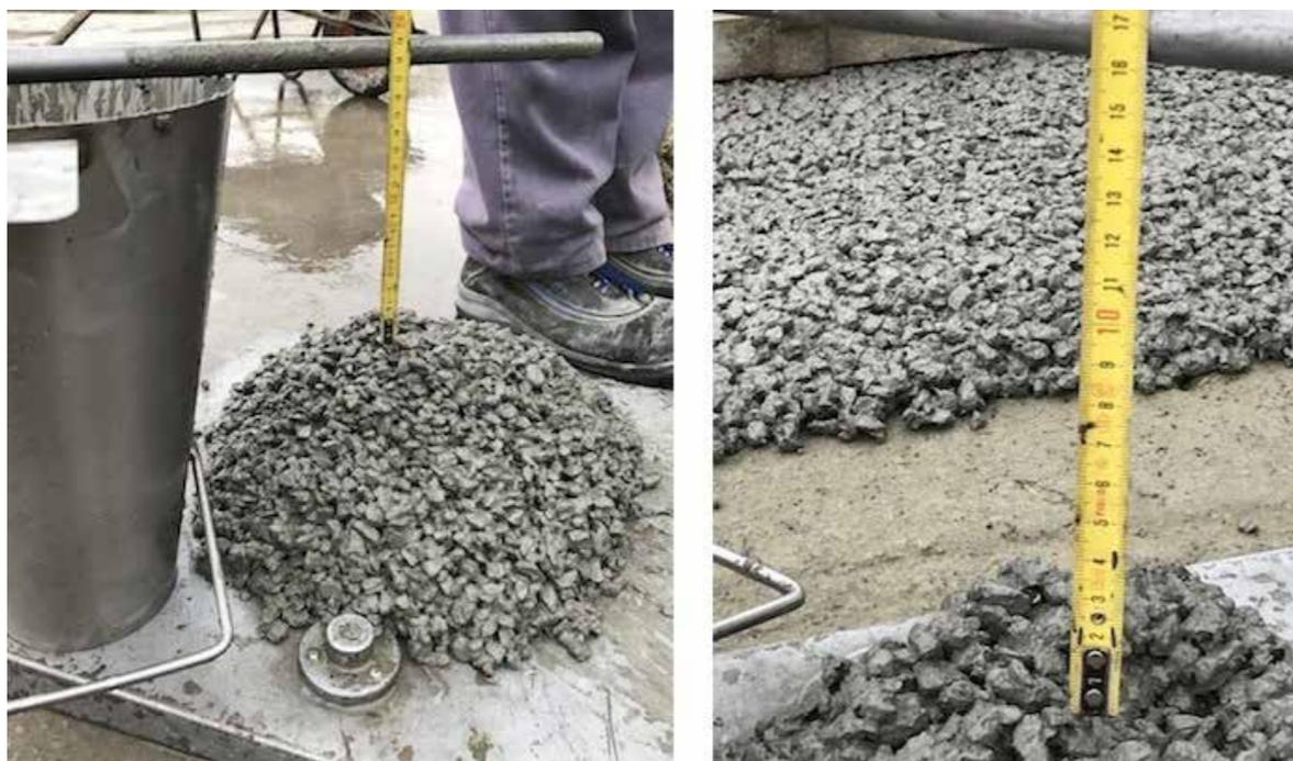
Valutazione della consistenza effettuata con cono di Abrams\_ nella prima immagine si vede l'abbassamento di 17cm dopo la miscelazione, la pasta è lucida e l'impasto è coeso; nella seconda immagine l'abbassamento è di 16cm dopo un'ora di miscelazione, la pasta si presenta ancora lucida ma inizia a disidratarsi
