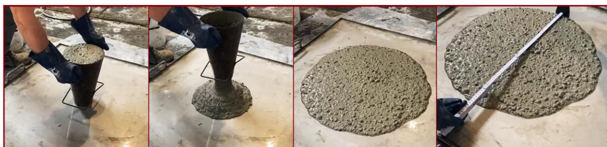
Figura 8 – Calcestruzzi speciali realizzati con i leganti della linea STRUCTURE FLOW consentono di realizzare in maniera estremamente semplice miscele molto performanti dal punto di vista reologico (SCC), particolarmente adeguate negli interventi di rinforzo di strutture esistenti.
