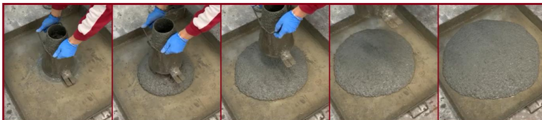
Figura 4 – Prova di spandimento sul betoncino STRUCTURE BF4-B
