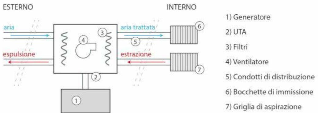
**Figura 1.** Rappresentazione schematica dei componenti di un impianto di climatizzazione.
