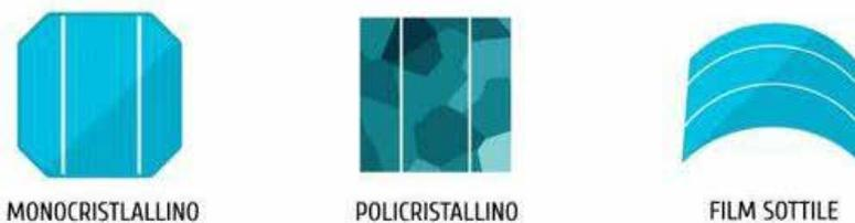
Figura 1 –Tipologie di celle solari. In evidenza le differenti sezioni e le composizioni cristalline.
