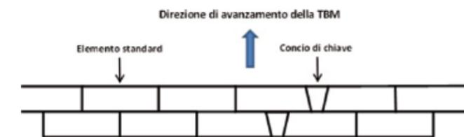
Figura 4 – Tipica disposizione di conci rettangolari e trapezoidali
