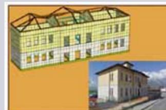
Figura 1 – modello per la valutazione della vulnerabilità sismica di un edificio scolastico.
