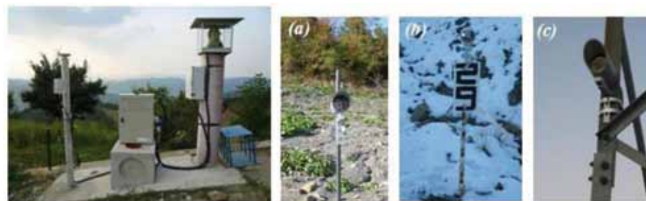
A sinistra il sistema di acquisizione dati formato da Total Station robotizzata, dispositivi di gestione, memorizzazione e trasferimento dati all'interno dell'armadietto e sistema GNSS differenziale per il controllo della stabilità del sito. A destra tre tipologie di installazione di target con prismi retroriflettenti.
