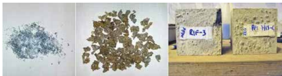
Aggregati riciclati R-PET in scaglie e granuli e provini delle miscele M0-II e M3-II
