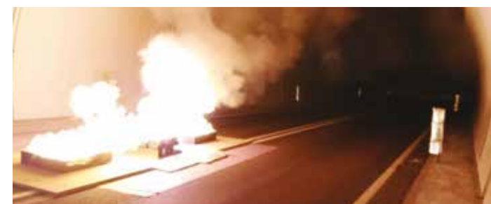
Simulazione di incendio in galleria
