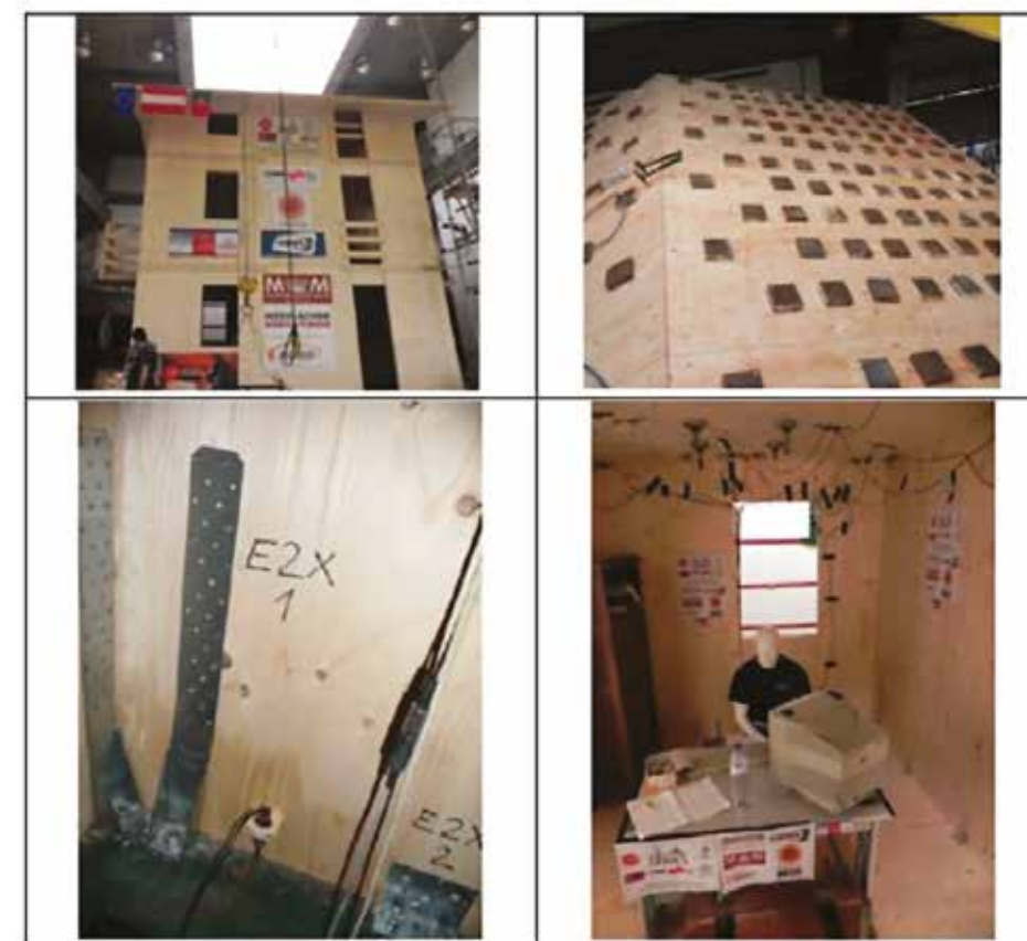
Edificio testato su tavola vibrante presso il laboratorio LNEC di Lisbona
