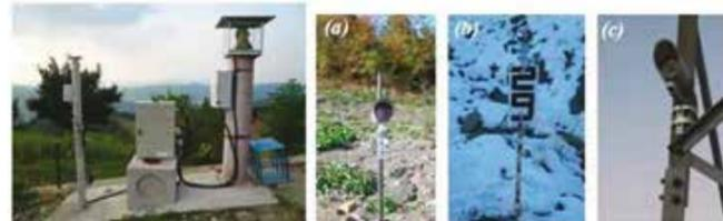
A sinistra il sistema di acquisizione dati formato da Total Station robotizzata, dispositivi di gestione, memorizzazione e trasferimento dati all'interno dell'armadietto e sistema GNSS differenziale per il controllo della stabilità del sito.
