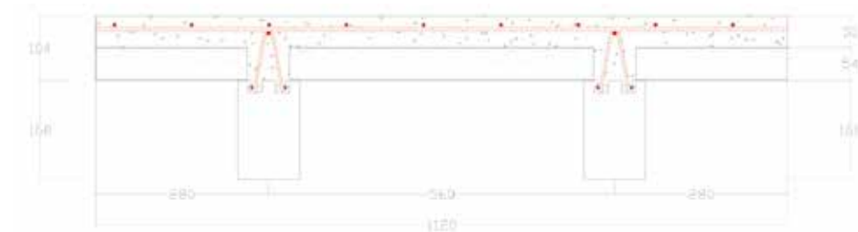
Geometria dell'elemento in legno lamellare e della sezione mista
