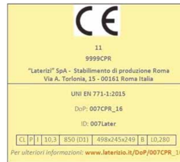
Figura 1 - Esempio di marcatura CE nell'ipotesi di etichettatura con codice di designazione
