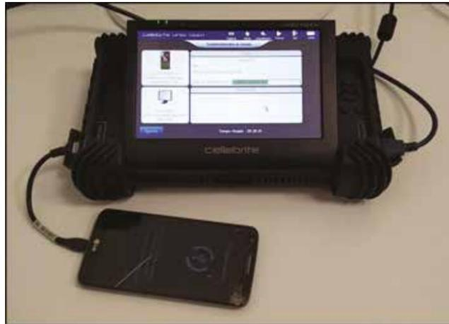
Figura 1 – Dispositivo LG G2 in modalità "Firmware update" durante acquisizione in modalità fisica utilizzando UFED Touch
