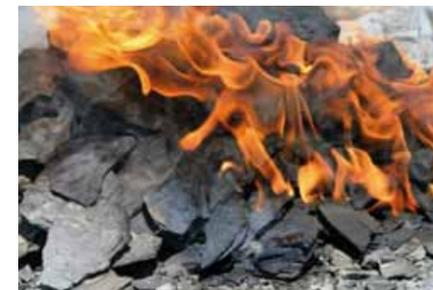
Figura 4 – Kimmeridge Clay (UK). Shale Oil intrappolato nell'argilla
