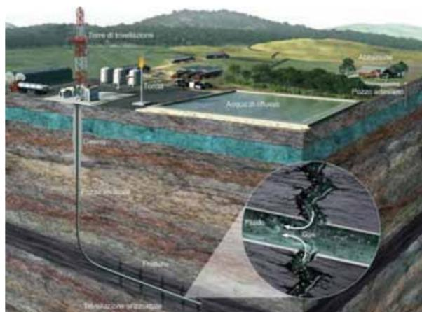
Figura 1 – Schematizzazione del processo estrattivo dello shale Gas & Oil
