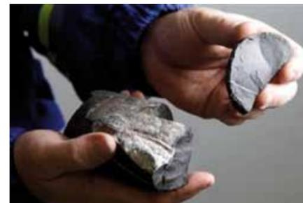
Figura 3 – Un campione di roccia in cui si trova intrappolato il Tight Oil
