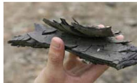
Figura 2 – Kimmeridge Clay (UK), argilla contenente Shale Oil. Da notare i piani di scistosità dell'argilla tra i quali resta intrappolato lo Shale Oil
