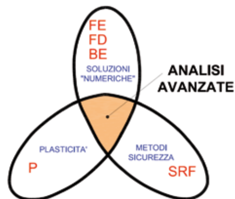
Figura 1 – Tipiche componenti del calcolo geotecnico avanzato (Rabuffetti – 2013)
