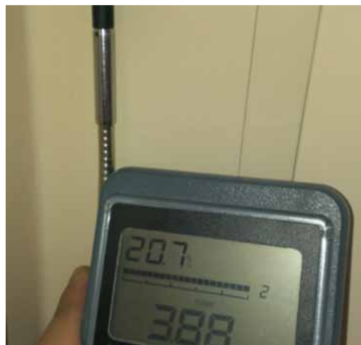
Figura 1 – anomala infiltrazione di aria durante un blower door test
