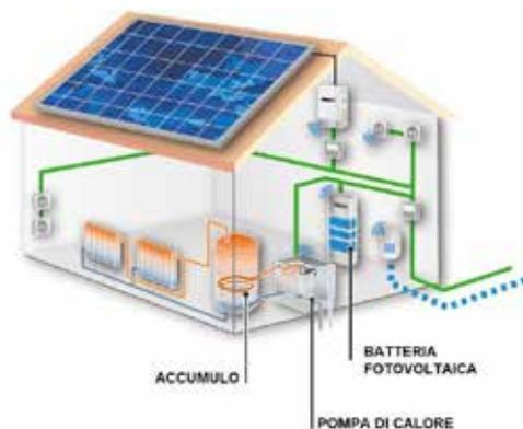
L'utilizzo delle pompe di calore idroniche come sistema principale per la produzione di riscaldamento, raffrescamento e acqua calda sanitaria sta prendendo sempre più quote di mercato a discapito dei combustibili fossili. In questo articolo affronteremo l'integrazione dell'impianto fotovoltaico con la pompa di calore, i suoi vantaggi e svantaggi e il dialogo fra i diversi sistemi.
