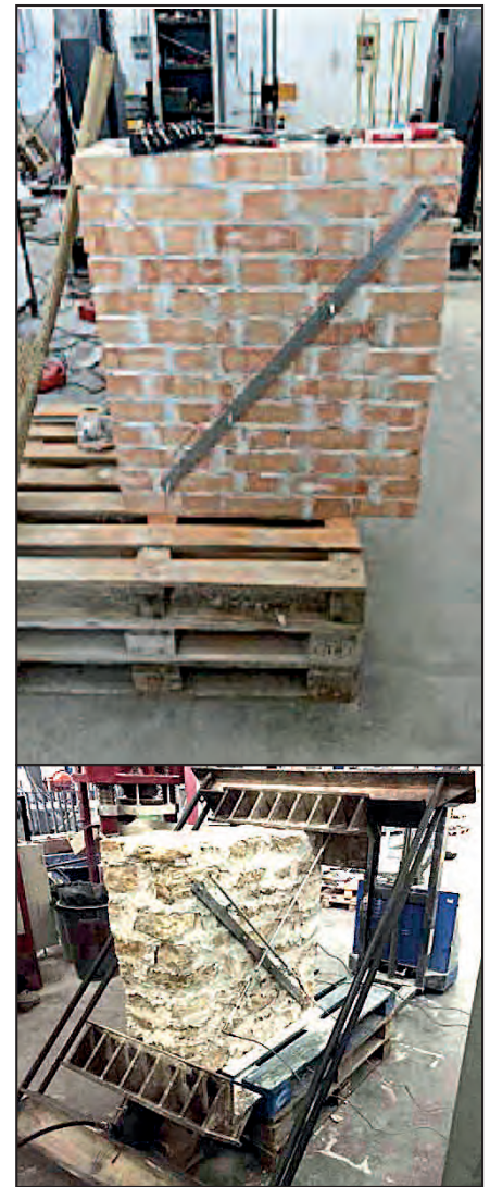
Figura 2: Provini rinforzati mediante lastre in acciaio inossidabile
