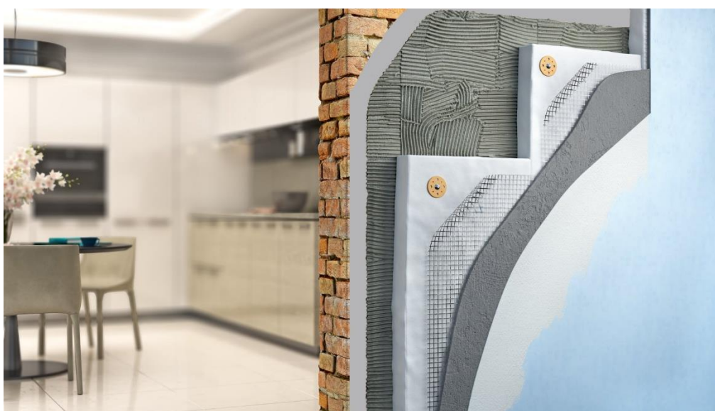
Stratigrafia di un cappotto termico esterno con EPS bianco, tasselli, rete e strati di finitura
