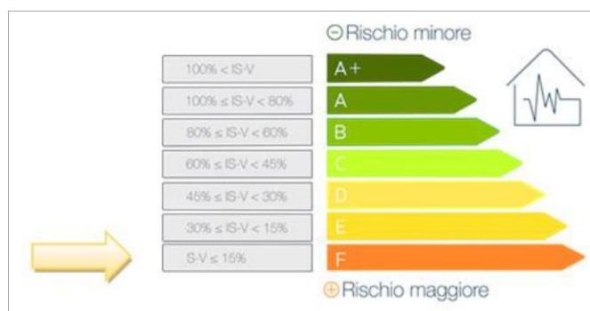
Figura 11 – Stima Livello di Sicurezza Sismico ante operam.
