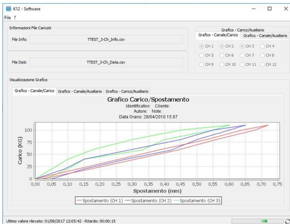
**Figura 2** - Schermata della CENTRALINA PORTATILE PER PROVE DI COLLAUDO T-TEST K12 Sw K12 di Boviari
